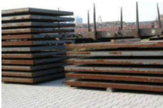
Bleche mit Kanthölzern unterlegt
